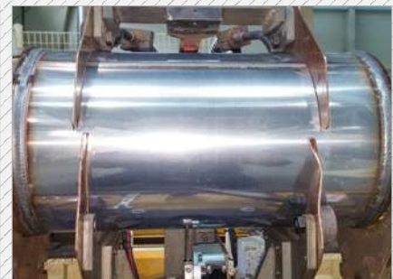
자동차 배기 시스템 조립 용접 Assembly welding of automotive exhaust system
