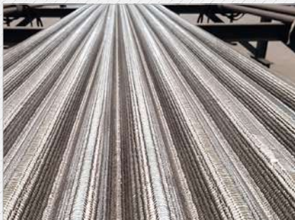
열교환 보일러 파이프 클래딩 용접 Weld cladding for boiler heat exchanger pipe
