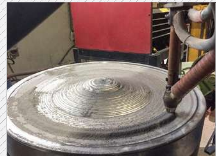
선박 엔진 밸브 (밸브 & 피스톤헤드) 육성 용접 Weld overlay on vessel engine parts (valve & piston head)
